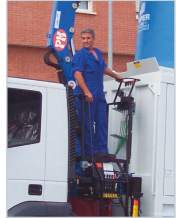
Raised control station: maximum angle of visibility. Puesto de maniobra en pie: máximo ángulo de visibilidad.
