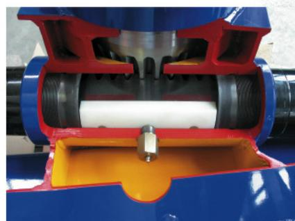
Nuova base con sistema di lubrificazione
