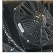
Heat exchanger. Cambiador de calor.
